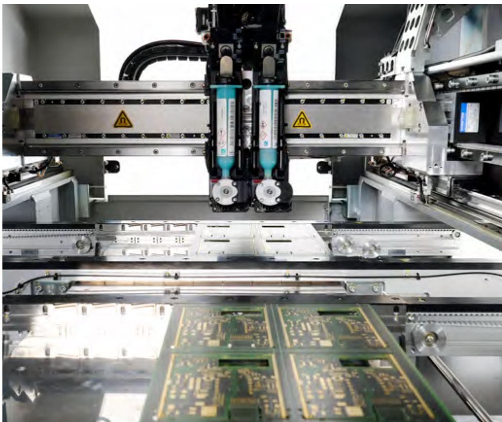
Jettingmaskin i färd med att påbörja jetting av lodpasta på en mönsterkortspanel.
